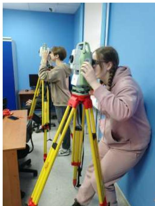
Техническая задача заключалась в установке ориентировки тахеометра, снятии 4 точек и расчете площади обозначенного участка.
